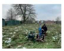
Pour des endroits où il est impossible d'effectuer des essais au pénétromètre avec un véhicule à chenilles (espace limité, caves, terrains inaccessibles,...), l'appareil démontable et portable peut être utilisé. Il faut ancrer l'appareil pour trouver la pression nécessaire pour réaliser l'essai (CPT).
